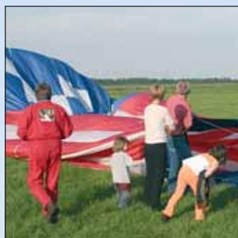
Nach dem Auspacken wird der Gasbrenner am Korb montiert, die Ballonhülle mit einem Kaltluftgebläse aufgeblasen um dann die Luft zum Aufrichten aufzuheizen.
